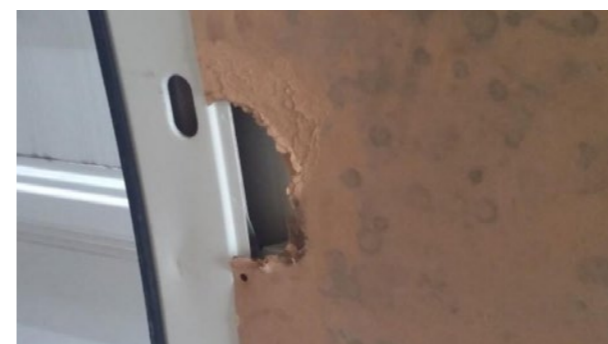
Protecții interne din lemn: Lovituri, panou rupt, panou lipsă (cu excepția panourilor superioare ale ușii)
